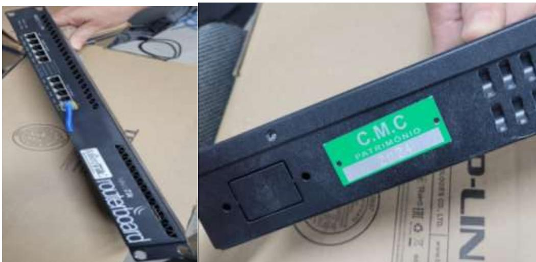
**Justificativa para desfazimento:** O routerboard controlador de bandas de internet foi danificado durante uma queda de energia, resultando em queima do equipamento. Após avaliação técnica, constatou-se que o conserto é inviável, sendo impossível restaurar sua funcionalidade.
